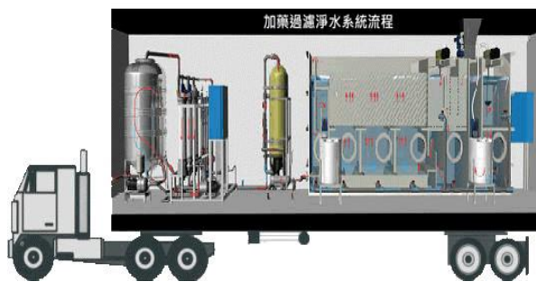
RO淨水設備
